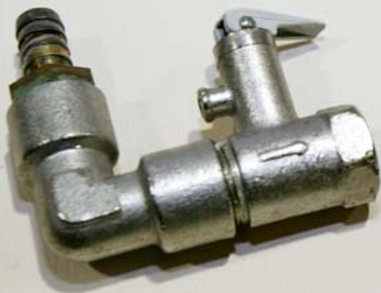
GAMMEL OG NY: Den gamle, fornikled overtrykksventilen (til venstre) bød på konstant lekkasje. Den kraftigere, nye til høyre er helt tett og har en mer effektiv avtappingsmulighet.
