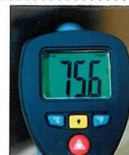
VED DYSEN INNE, ETTER ISOLERING: Vi målte temperaturen ved hoveddysen i salongen. Da var alle andre dyser stengt. Etter at vi isolerte varmluftslangene var temperaturen cirka 84 grader. Altså cirka 9 grader høyere enn før isolering.
