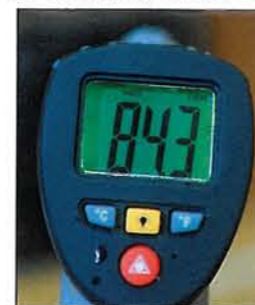
VED DYSEN INNE, ETTER ISOLERING: Vi målte temperaturen ved hoveddysen i salongen. Da var alle andre dyser stengt. Etter at vi isolerte varmluftslangene var temperaturen cirka 84 grader. Altså cirka 9 grader høyere enn før isolering.
