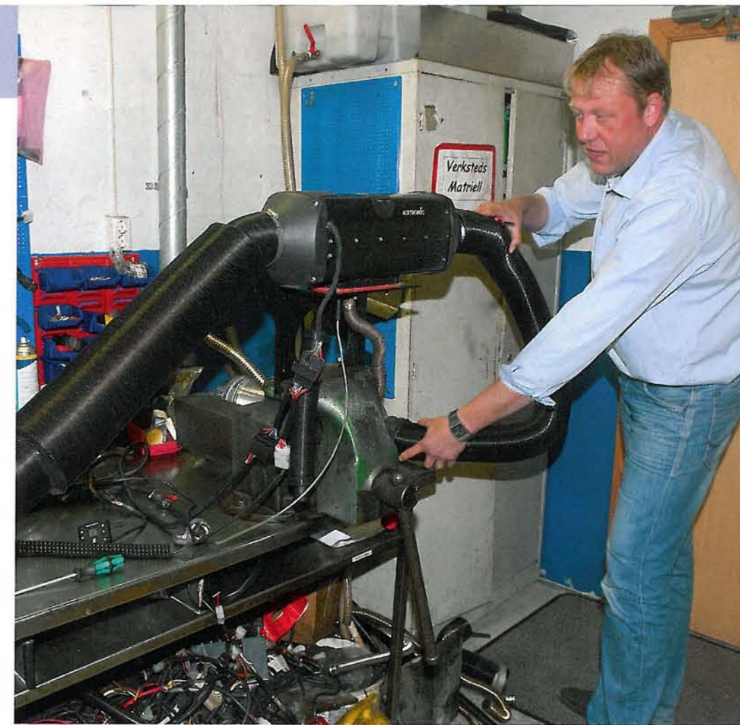
MINDRE STØY: Vi har ikke foretatt lyd-målinger for å se hvor mye støyen reduseres, men fikk Ove Jarle Thomassen hos Diesel og Elektro til å prøvekjøre dieselvarmer med lydfelle på utluft og på innluft. Med lydfellene påsatt var det betydelig mindre støy.
