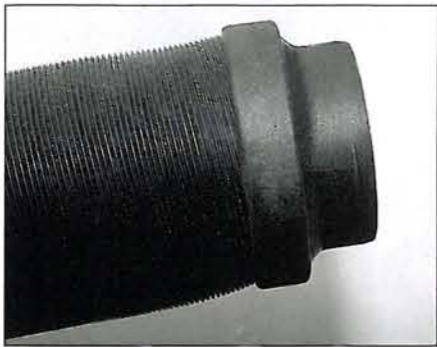
PLUNDER Å TRÆ: Det er et plunder å få luftslangene gjennom isolasjonsstrømpen. Det er lettere om man setter en avrundet stuss på enden av luftrøret.
