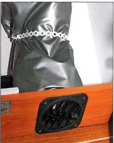
FESTES: Alle luftslanger, med eller uten isolasjon, skal festes. Det kan gjøres med buntbånd eller plastbelagt patentbånd.
