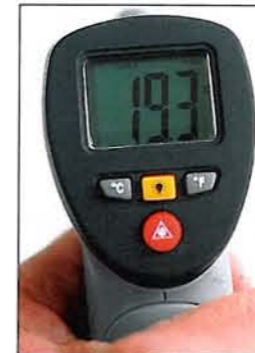
OMGIVELSESTEMPERATUR: Da vi foretok målingene for overflatetemperaturen på varmluftslangene var omgivelsestemperaturen cirka 19 grader.
